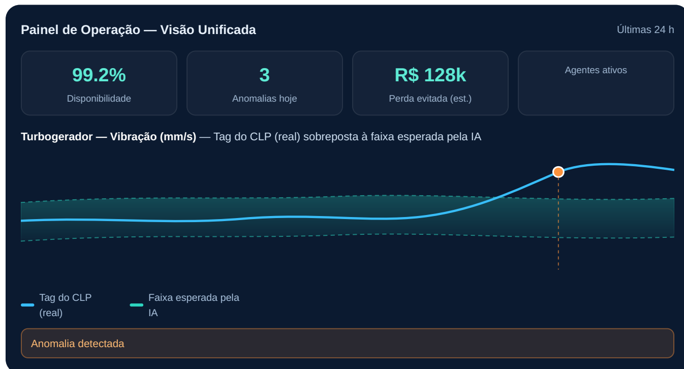
Figura 2 · Painel unificado (ilustrativo): a tag do CLP em tempo real e a faixa esperada pela IA, com anomalia sinalizada.
