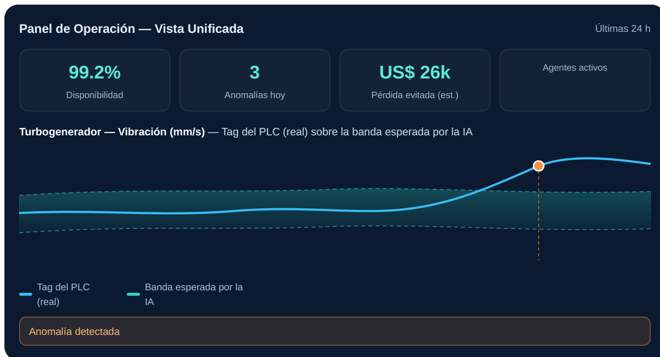
Figura 2 · Panel unificado (ilustrativo): el tag del PLC en vivo y la banda esperada por la IA, con la anomalía señalada.
